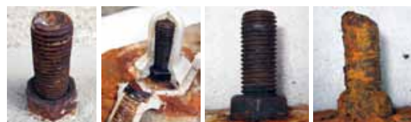
Figure14 試験状況 防錆塗布あり 塗布なし
