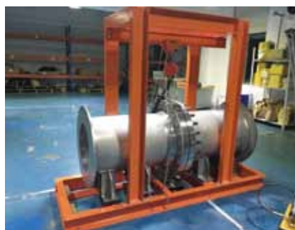
Figure2 試験治具(JPI Class300 24inch)
