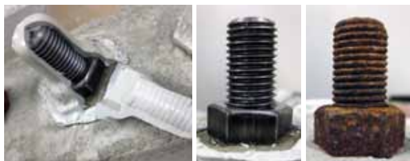
Figure13 試験状況 防錆塗布あり 塗布なし
