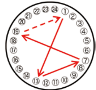
Figure5 JIS仮締付けの締付方法
