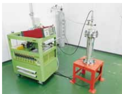
Figure1 試験治具(JPI Class150 4inch)
