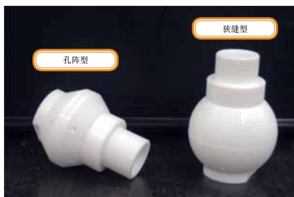
Figure6 旋转式喷射球™的喷嘴(不同类型)
