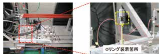
Figure6 高圧水素ガスサイクル試験 試験機外観
