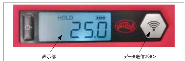
Figure4 表示部とデータ送信ボタン
