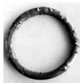
Figure2 ブリストアが発生したOリング例
