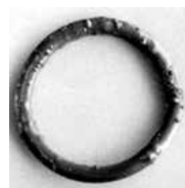
Figure2 ブリストが発生したOリング例
