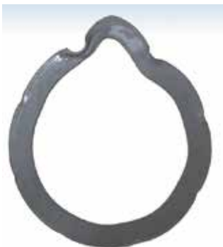
Figure4 片締め(一部締付け不足)による変形事例
