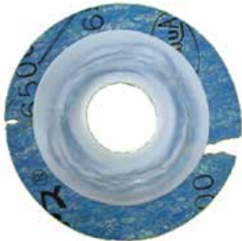
Figure3 過剰締付けによる圧壊事例
