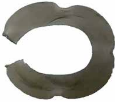
Figure2 締付け不足によるガスケット吹飛び事例
