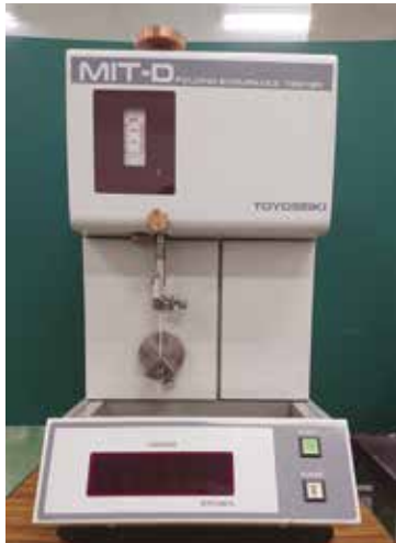
Figure7 MIT試験装置
