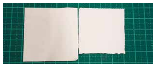
Figure2 PTFEナノファイバー不織布(左)と延伸PTFE(右)の熱収縮性の違い
