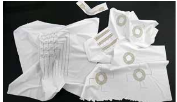
Figure10 種々の配線パターンを形成したPTFEナノファイバー
