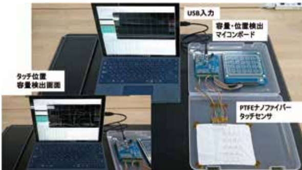
Figure13 タッチセンサー試作品 (マイコンボード及び表示ソフトはルネサス社製品を利用)
