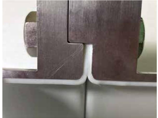
Figure4 締結後の接合部の写真
