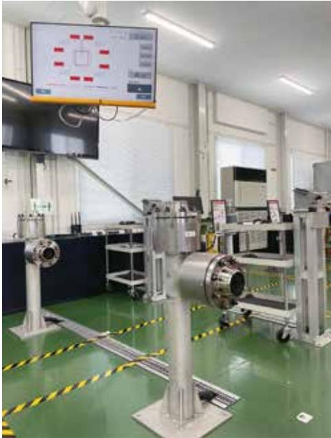
Figure7 フランジ締付けトレーニング実習装置
