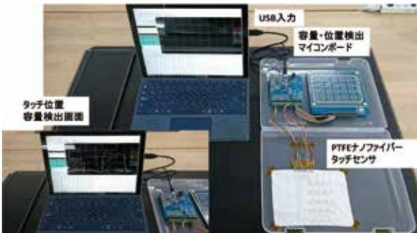
Figure13 タッチセンサー試作品
