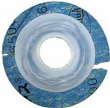
Figure3 過剰締付けによる圧壊事例
