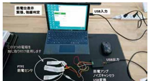
Figure11 筋電センサー試作品
