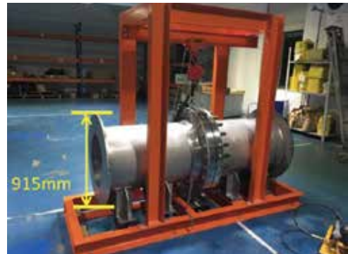
Figure2 JPI Class300 24inch 管フランジ締結体の試験装置
