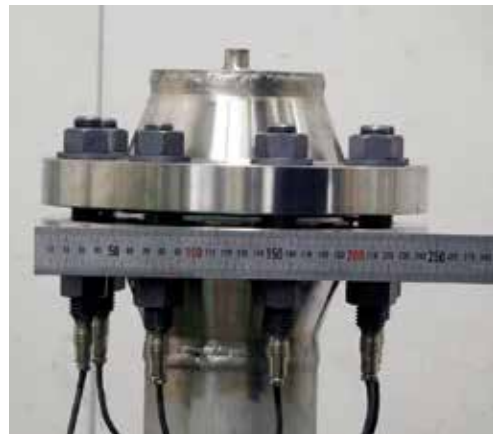
Figure1 JPI Class300 4inch 管フランジ締結体の試験装置
