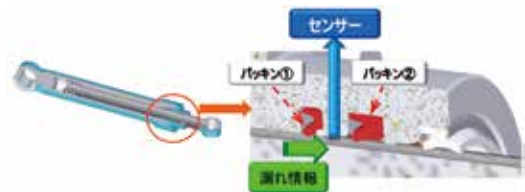
Figure9 パッキン構造
