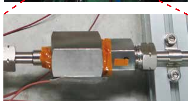
Figure6 高圧水素ガス圧力サイクル試験 試験機・継手外観
