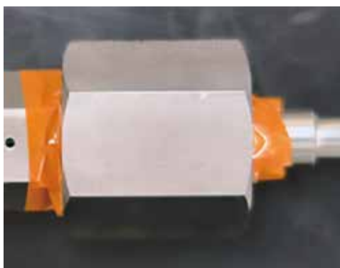
Figure9 試験後の継手と水素ガス検知テープの状態
