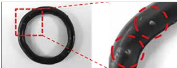
Figure2 プリスターが発生したOリング
