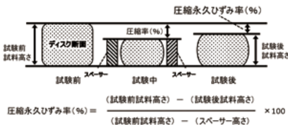
Figure3 圧縮永久ひずみ率の測定、及び算出方法
