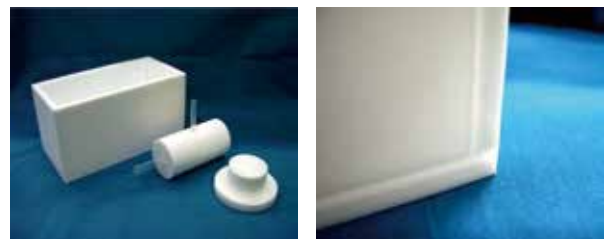
Figure1 バルフロン溶接加工品と溶接部の例
