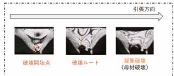
Figure4 破壊ルートと応力伝播の観察像
