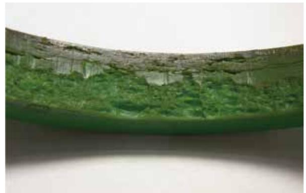
Figure3 劣化した油圧シリンダ用パッキン (Uパッキン内径側)
