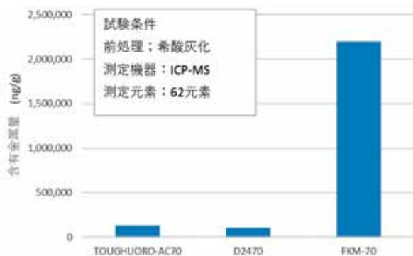
Figure6 TOUGHUORO ® -AC70の含有金属測定結果
