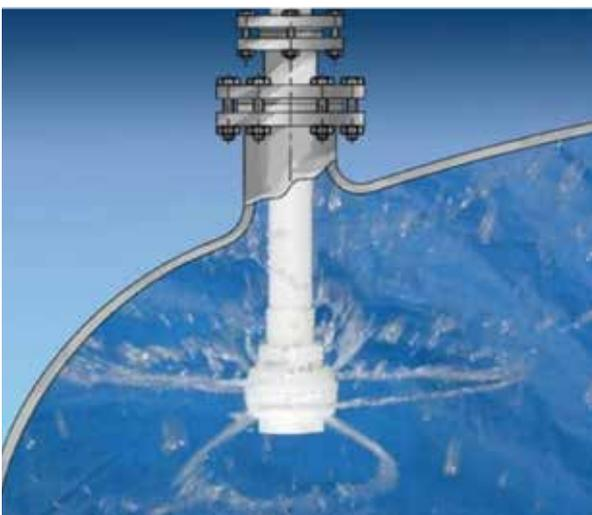
医療・化学・食品などあらゆる業界の反応槽、攪拌槽、貯槽などのタンク内の洗浄用ノズルとして使用する。接液部はPTFEであるため耐熱・耐薬品性を生かし、タンク内に常時装着しておくことが出来る。内部に回転用の部品はなく、洗浄水そのものが回転をコントロールするシンプルな構造であり、散水する上下ボールが逆回転し洗浄する。回転・噴射時に静電気が蓄積されるため、使用環境が引火性流体である場合は、回転式スプレーボール®の材質は帯電防止PTFEが推奨される。
