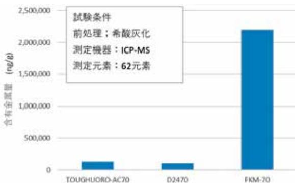
Figure6 TOUGHUORO<sup>®</sup>-AC70の含有金属測定結果
