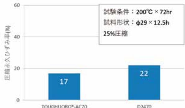
Figure5 TOUGHUORO<sup>®</sup>-AC70の圧縮永久ひずみ率
