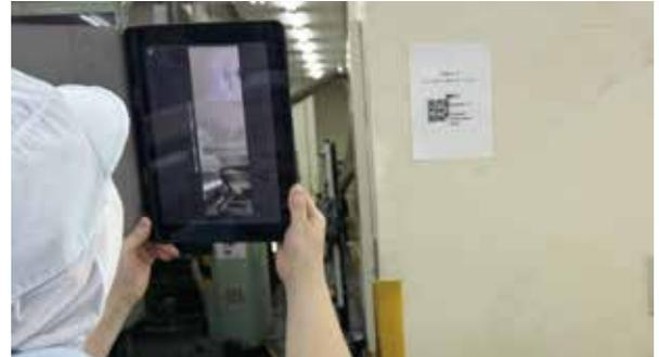
Figure6 二次元コード機能の活用により簡単に点検表へアクセス
