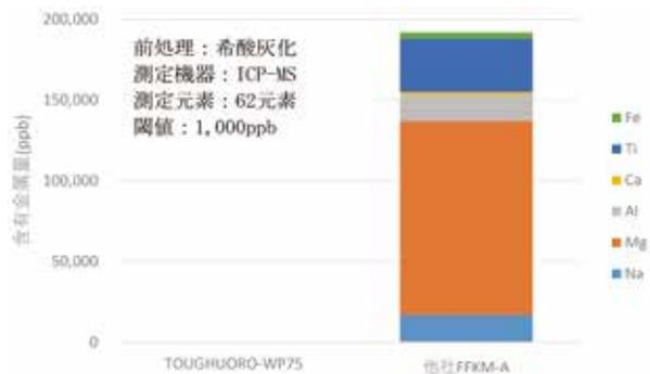
次に、半導体洗浄工程でよく使用される高純度塩酸に TOUGHUORO<sup>®</sup>-WP75 を浸漬させ、浸漬液への金属成分の溶出を確認した。36% 高純度塩酸水溶液に25℃×168時間浸漬後の浸漬液への各金属成分の溶出量を測定した結果、TOUGHUORO<sup>®</sup>-WP75の溶出量は、測定した金属成分については、検出限界以下(閾値100ppb)であった。同じ条件で評価した、半導体 wet 用途で使用されている他社 FFKM 品は、数種類の金属成分の溶出が確認された。これら結果から、TOUGHUORO<sup>®</sup>-WP75 が、高純度塩酸への耐性があることが確認出来た。Figure3に
