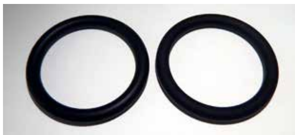
Figure5 再生品Oリング(右)とバージン品Oリング(左)
