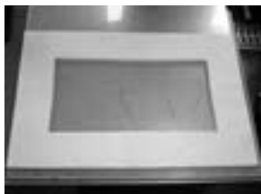
写真2 融着した大型額縁状素材各辺の中央四カ所で融着 寸法 800mm×550mm×t15mm
